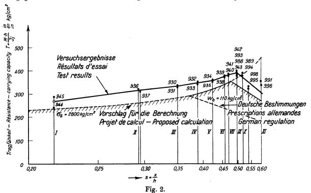
Tragfähigkeitslinie nach Versuch und Rechnung (gestrichelte Linie) und nach Vorschlag für St. 37 (schraffierter Rand).
