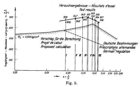
Tragfähigkeitslinie nach Vorschlag für hochwertigen Betonstahl.
