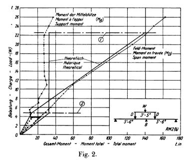
Versuche an durchlaufenden Balken. Bruch des Stahles (b). Beton mit frühhochfester Zement-Mischung 1:1:2 (in Gewicht) Wasser-Zementfaktor = 0,44 (in Gewicht). Alter beim Versuch = 44 Tage. Würfelfestigkeit = 6660 lb/in².
