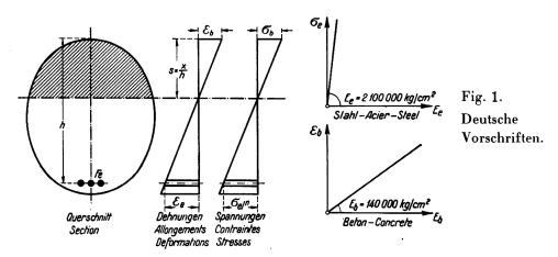
der Elastizitätsmaße von Stahl und Beton ist mit n = 15 anzunehmen. Der Zusammenhang von Spannung und Dehnung wird sowohl für den Stahl, als auch für Beton geradlinig angenommen (*Hooke*'sches Gesetz).
