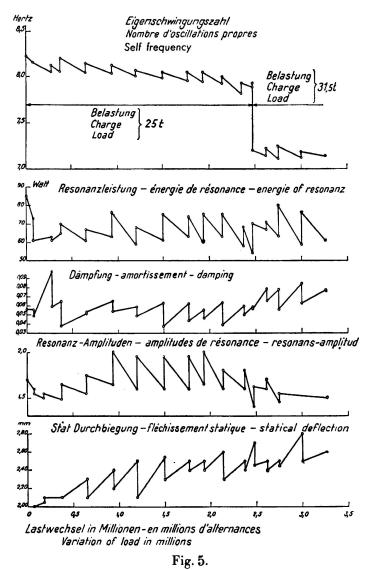
Dauerversuch: Änderung der dynamischen Werte mit zunehmender Ermüdung.
