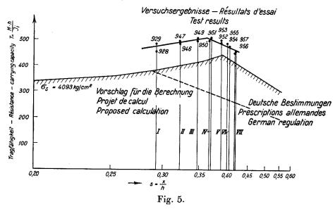
Tragfähigkeitslinie nach Vorschlag für hochwertigen Betonstahl.
