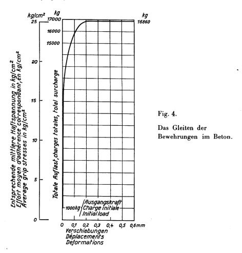
Diese Möglichkeit zum Gleiten ohne Aufhebung des Verbunds gestattet erst die Übertragung von Kräften von einem Stabe zum anderen mittels des Betons. Es ist in der Tat unmöglich, daß ein Stab auf einen benachbarten Stab die in ihm herrschende Zugkraft überträgt, ohne daß zwischen den beiden Stäben und dem
