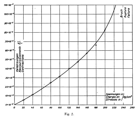
Spannungs-Dehnungskurve des Betons.
