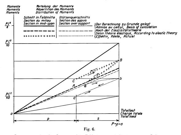
Spannungen über den Stützen und in Feldmitte eines halb-eingespannten Balkens.
