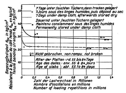
Abmessungen 20×40×170 cm , Auflagerentfernung 150 cm 2 Lasten im Abstand von 50 cm , 6u beim Dauerversuch 4,9-5,2 kg/cm² Dimensions 20×40×170 cm , distance des appuis 150 cm 2 charges à la distance de 50 cm , 6u pour l'essai à la fatigue 4,9-5,2 kg/cm² Dimensions 20×40×170 cm , distance of supports 150 cm 2 loads 50 cm apart , 6u for fatigue test 4,9-5,2 kg/cm²
