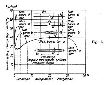
als auch beim übereck gestellten Quadrat (Fig. 13) Versuchswerte, die fast genau der Biegekennlinie k = 1 entsprechen, desgleichen beim Rundstab aus Stahl C. Diese beiden Stahlsorten hatten also keine obere Streckgrenze. Es gelang sehr leicht durch entsprechende Glühbehandlung Korngrenzenzementitausscheidungen
