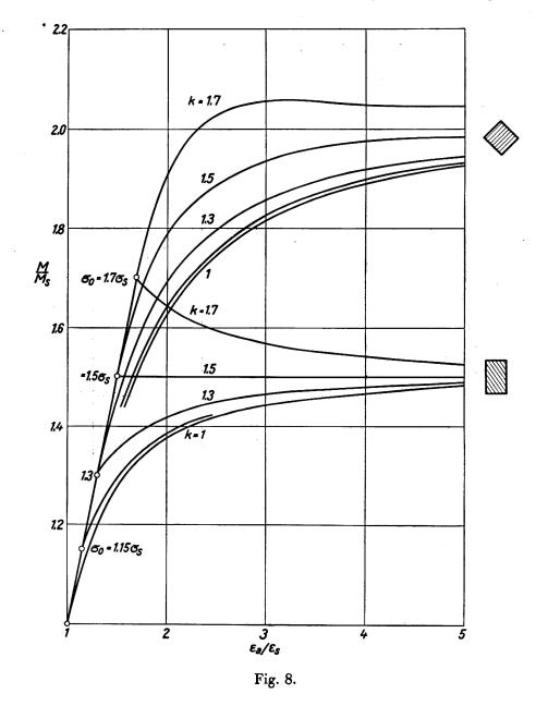
berechneten Biegekennlinien bauen sich gerade auf diesen Grenzfall auf. Bei Zugversuchen mit undeutlicher Streckgrenze, bei welcher kein deutlicher Knick in der Spannungsdehnungslinie, sondern ein allmählicher Übergang erfolgt, hat man sich auf die 0,2 % Dehngrenze als Ersatz für die Streckgrenze geeinigt, um ein einheitliches, von Willkür freies Prüfverfahren anwenden zu können. Dieses Hilfsmittel versagt beim Biegeversuch, wie folgende Überlegung zeigt:
