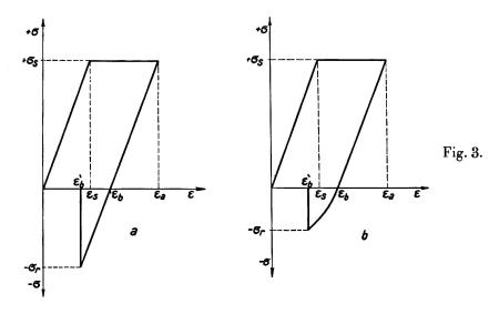
keine bleibende Dehnung zeigte. Aus dem Unterschied der nach einer bestimmten Gesamtdehnung auftretenden bleibenden Dehnung beim Biegeversuch und der bleibenden Dehnung, die beim Zugversuch aufgetreten wäre, kann auf die Restspannung geschlossen werden (vgl. Fig. 3 a b).
