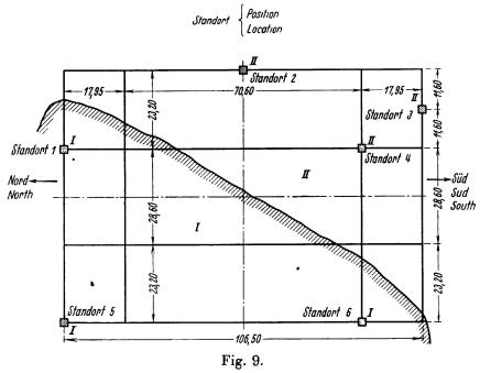
Lageplan für eine dynamische Bodenuntersuchung: Standorte des Schwingers im Grundriß des geplanten Gebäudes. Die schraffierte Linie gibt die Grenze zwischen gutem und weniger gutem Baugrund an.
