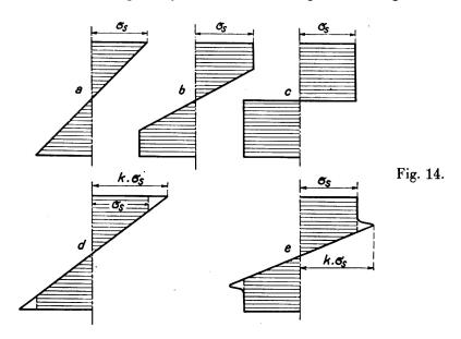
weichungen, die als die Wirkung einer oberen Streckgrenze des Werkstoffes erkannt wurden. Bei weichem Kohlenstoffstahl scheint eine obere Streckgrenze die Regel zu sein, während Stahl ganz ohne obere Streckgrenze eine Ausnahme bildet. Der weiche Kohlenstoffstahl R und der vergütete Chromnickelstahl C ergaben sowohl beim flachliegenden Rechteck- bzw. Quadratquerschnitt (Fig. 12),
