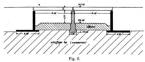
Feuchtigkeit erfolgen können, d. h. umso schneller wird er sich unter einer aufgebrachten Last verdichten. Während dieser Vorgang bei Sanden nahezu plötzlich erfolgt, dauert er bei bindigen Böden (Ton, Lehm usw.) je nach deren Durchlässigkeit und Schichtstärke oft viele Jahre lang. Zwischen den beiden Extremen Sand und fetter Ton liegen eine große Anzahl von verschiedenen Böden und damit von zu erwartenden Setzungsgeschwindigkeiten.
