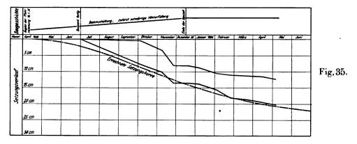
liches Widerlager zwischen 20 und 45 mm, Pfeiler im Mittel 15 mm, Bauwerk zur Ruhe gekommen, keine Schäden (starke Setzung der Widerlager durch Hinterfüllung des Bauwerks bedingt).
