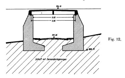
Dreigelenkbogen, 14 m Stützweite, Flachgründung auf tiefgründigem Löß (Fig. 24), Bodenpressung 2,6 kg/cm<sup>2</sup>. Bauwerk fertiggestellt Juni 1935, Setzung bis April 1936 etwa 40 mm, Bewegung klingt aus, keine Schäden (Fig. 3).
