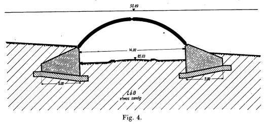
III. Setzungsbeobachtungen an einer Anzahl fertiger Brückenbauten der Reichsautobahnen.
