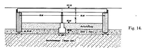
(schwimmende Pfahlgründung). Bodenpressung auf Fundamentunterkante etwa 1,1 kg/cm², Untergrund besteht aus Schluff von über 40 m Mächtigkeit, nat. Wassergehalt 34-64%, Fließgrenze 35-72%, Rollgrenze 8-28%, Durchlässigkeit  $3,7 \cdot 10^{-5}-1,3 \cdot 10^{-4}$  cm/min. (Kornverteilung vgl. Fig. 26.) Fertig-
