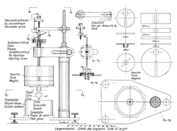
${\bf Fig.~9}.$  Zeichnung des Kegelapparates (Einzelheiten).
