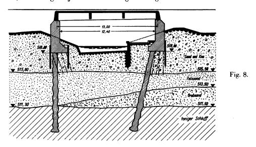
Stärke, darunter unregelmäßig gelagerte Kies- und Mergelschichten sowie Fels. Fertigstellung des Bauwerks Dezember 1935, max. Setzung der Pfeiler 52 mm, letzte Messung im März 1936, Bauwerk bewegt sich weiter, keine Schäden.
