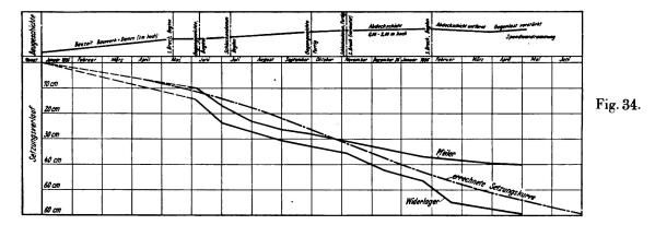
mittlere Bodenpressung für Widerlager 1,4 kg/cm², für Pfeiler 1,5 kg/cm². Fertigstellung des Bauwerks August 1935, eingetretene Setzungen westliches Widerlager zwischen 22 und 100 mm (Rollenlager wurde angehoben) und öst-
