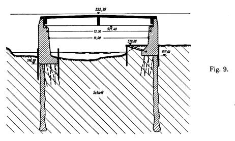
16,0—21,3 %. Fließgrenze von 29,9—56,3 %. Rollgrenze von 15,7—18,8 %. Bodenpressung etwa 1,5 kg/cm² für Widerlager und 1,0 kg/cm² für Pfeiler. Bauwerk beendet August 1935, Setzungsvoraussage etwa 150 mm für Widerlager und 60 mm für Pfeiler, eingetretene Setzung etwa 46 mm für Widerlager und 25 mm
