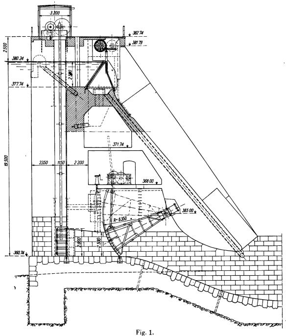
Querschnitt durch die Wehranlage.
