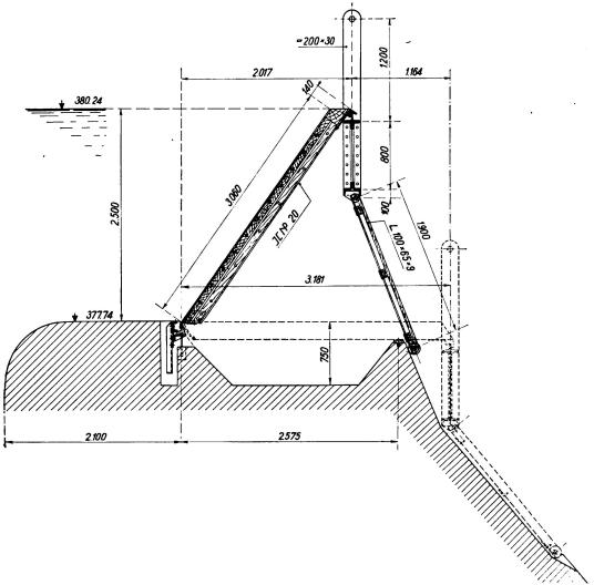
Fig. 8. Querschnitt durch Überfallklappe,
