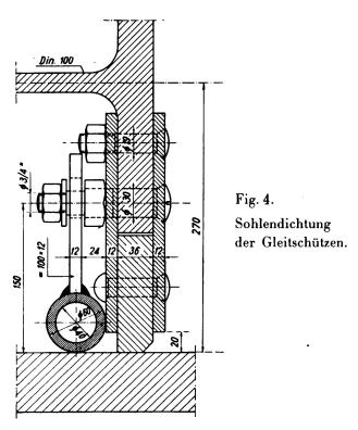
Die Dimensionierung der Gleitschützen erfolgte für einen statischen Druck von 20,0 m Wassersäule nach den eidg. Verordnungen betr. Stahlbauten.
