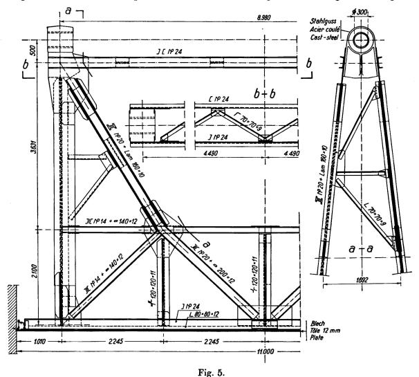
Stahlkonstruktion der Segmentschütze.
