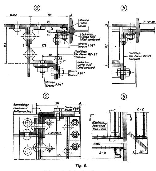
Dichtungseinzelheiten der Segmentschütze.
