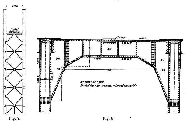
Der Versteifungsträger hat einwandigen Querschnitt, der Stabbogen ist dagegen zweiwandig ausgebildet. Der Versteifungsträger ist mit Hängestangen aus Rundeisen am Stabbogen aufgehängt.
