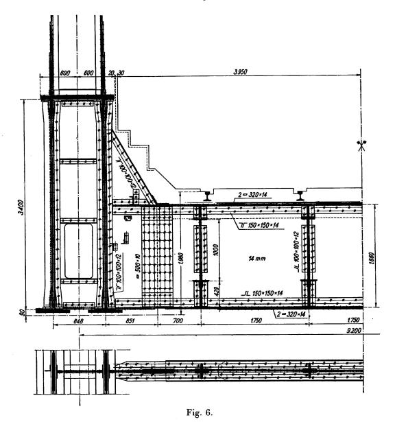
öffnungen am Widerlager rund 26 m Stützweite. Die ganze Brücke ist genietet. Das Stegblech der einwandigen Träger der Endöffnungen ist 3,2 m hoch, die Stegblechhöhe der doppelwandigen Träger der Seitenöffnungen geht von 3,2 m sanft auf 4,8 m an den Pfeilern der Hauptöffnung über. Fig. 5 zeigt die Ausbildung des Hauptträgers am Bogenende, Fig. 6 einen Querträger.
