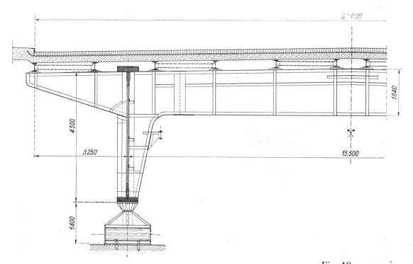
Fig. 19. Querträger über dem Lager.
