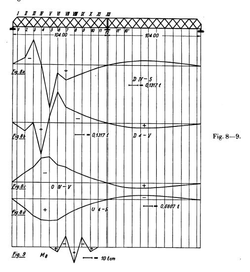
Die Einflußlinie für das Biegungsmoment im Untergurtstab ergibt bei ungünstigster Belastung nach Lastenzug N Biegungsspannungen von etwa 260 kg/cm². Bei Überlagerung mit den Einflußlinien der Stabspannungen ergaben sich jedoch nur zusätzliche Biegungsspannungen von etwa 10 kg/cm², die praktisch als ganz unwesentlich zu bezeichnen sind.
