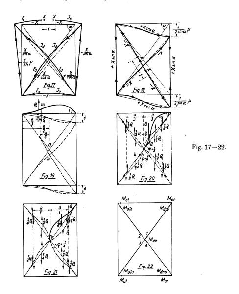
noch eine Drehung der starren Pfosten gegeneinander um den Winkel  $\vartheta$ , der sich in diesem Falle entsprechend der Gleichung 10 ergibt:
