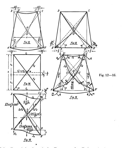
für die Behandlung belanglos, ob der Träger an den Enden mit einer ganzen Raute (Fig. 10b) oder mit einer halben Raute (Fig. 10a) abschließt. Der letztere Abschluß ist übrigens, wie die Nachrechnung der Weseler Rheinbrücke ergab, statisch entschieden vorzuziehen. Als Hauptsystem wählen wir den Träger Fig. 11a, der in jeder Raute einen starren Pfosten enthält, welcher biegungsfest mit den Gurtstäben und Streben verbunden ist.
