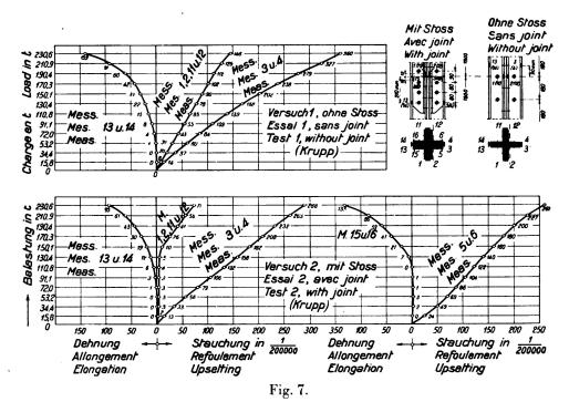
Stauchungsmessungen an 2 außermittig gedrückten Stützen. (Stauchungen in mm 10-4 auf 20 mm Meßlänge, zugehörige Meßwerte gemittelt).
