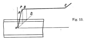
Steigt das Biegungsmoment, so dreht sich die Gerade O D im Uhrzeigersinn. Es ändert sich von der Größe  $M_o$  zur Größe  $M_1$  in der plastischen Zone, während der Punkt B der Kurve, der mit dem Punkt P gleichgesetzt werden kann, sich nach C verschiebt. Es wird ziemlich genau
