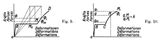
Dann ist der Schwerpunkt M der charakteristischen Punkte sehr nahe an der Kurve C  $\Phi_1$  selber (Fig. 10). In angenäherter Weise kann man daher den gefährlichen Wert der mittleren Beanspruchung als denjenigen bezeichnen, der auf der Formänderungskurve der k-fachen gefährlichen Verlängerung entspricht.
