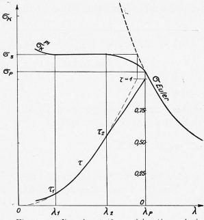
Fig. 2. — Représentation schématique de la relation entre la contrainte de flambage et le coefficient de flambage = Schematische Darstellung des Zusammenhangs zwischen Knickspannung und Knickzahl = Diagrammatic representation of connection between buckling stress and buckling coefficient.
