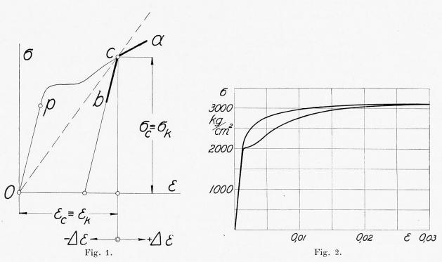
Abhängigkeit der in verschiedenen Querschnittspunkten gleichzeitig wirkenden Spannungen  $\sigma$  von den zugehörigen spezifischen Verkürzungen  $\varepsilon$  angibt, ist infolgedessen während der Ausbiegung des Druckstabes jederzeit durch den Linienzug bea bestimmt.
