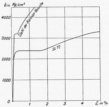
Fig. 4. — Acier employé par Kármán — Stahl der Kármán-Versuche — Steel of Kármán test.
