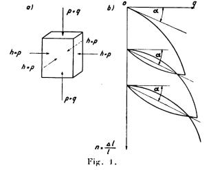
des Sandes das folgende Bild! Nehmen wir an, Fig. 1 a stelle das prismatische Element einer Sandmasse dar. Die Kantenrichtung decke sich mit der Richtung der Hauptspannungen. Die Grösse sämtlicher Hauptspannungen sei gleich p. Lässt man den Wert der lotrechten Hauptspannungen um einen Zusatzbetrag q zunehmen, während die wagrechten unverändert bleiben, so sollte man für die Beziehung zwischen der lotrechten Zusatzspannung q und
