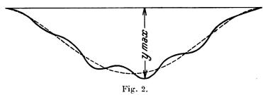
Masstab in Abb. 2 dargestellt. Die grösste Durchbiegung tritt etwas seitwärts der Mitte auf. Da die erzwungenen Schwingungen verhältnismässig langsam sind, so tritt bei der Steifigkeit der heutigen Brücken
