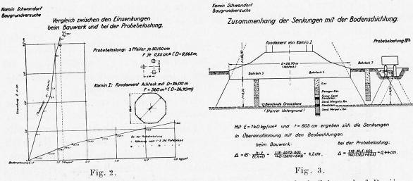
Fig. 2. — Essai du sol de fondation pour les cheminées de la centrale de Schwandorf, Bavière = Kamin Schwandorf, Baugrundversuche = Schwandorf chimney. Tests of foundation soil.
