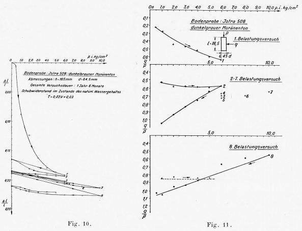
Fig. 40. — Essai de sol Istra 508, argile morainique brun-foncé. — Bodenprobe : Istra 508, dunkelbrauner Moranenton. — Soil test : Istra 508, dark-brown Moraine clay.
