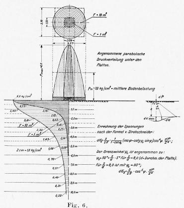
Répartition parabolique supposée au-dessous de la dalle. — Angenommene parabolische Druckverteilung unter den Platten. — Assumed parabolic distribution of pressure under the plates.
