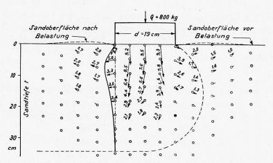
Fig. 1. — Surface du sable après la mise en charge = Sandoberfläche nach Belastung = Sand surface after loading.
