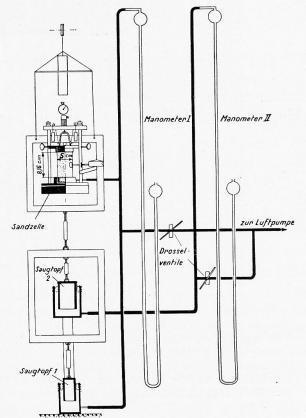
Fig. 2. — Manometer. Pressure gauge. — Sandzelle — éprouvette de sable — Sand cell. Saugtopf — chambre d'aspiration — Suction cylinder. Drosselventile — robinet — Throttle valve. Luftpumpe — pompe à air — air pump.
