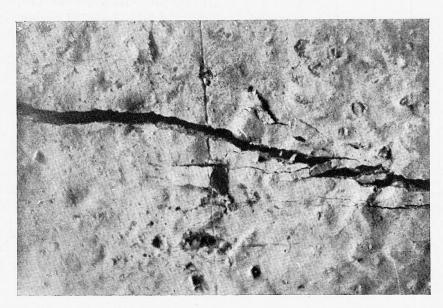
Fig. 11. — Fissure longitudinale et destruction du béton par compression. Längsriss und Druckzerstörung des Betons. Longitudinal cracking and destruction of the concrete by pressure.
