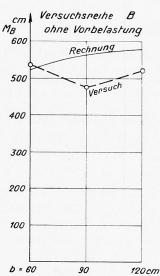
Fig. 13. - Moments de rupture.
