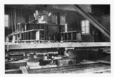
Fig. 4. — Dispositif d'essai avec poutres, avant l'essai. Versuchseinrichtung mit Trägern vor dem Versuch. Testing arrangement with beams, before the test.
