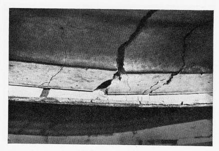
Fig. 9. — Fissures de traction dans les voûtins (à la rupture).
