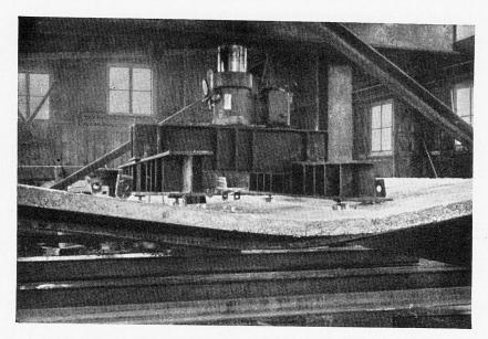
Fig. 5. — Dispositif d'essai avec poutres, après l'essai.
