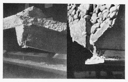
Fig. 6. — Déplacement des poutres anx extrémités. Gleiten der Träger, Trägerende. Slipping of the beams at the ends.
