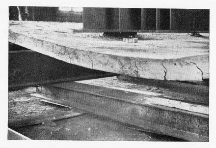
Fig. 10. — Fissures de traction sur les bords de la dalle (à la rupture).
