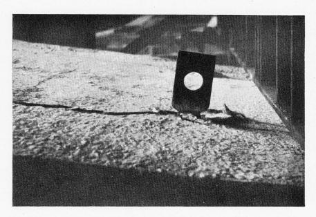
Fig. 7. — Déplacement des poutres et destruction du béton aux crochets de mise en charge.
