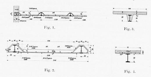
und in der Nähe der Fliessgrenze über 45% kleiner ist, als jene der freistehenden Stahlträger; dieser Umstand spricht dafür, dass die einbetonierten Stahlträger gewissermassen tragfähiger sind als die freiliegenden, woraus folgt, dass sie auch wirtschaftlicher sind.
