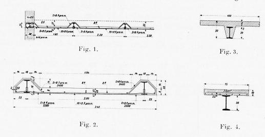
und in der Nähe der Fliessgrenze über 15% kleiner ist, als jene der freistehenden Stahlträger; dieser Umstand spricht dafür, dass die einbetonierten Stahlträger gewissermassen tragfähiger sind als die freiliegenden, woraus folgt, dass sie auch wirtschaftlicher sind.
