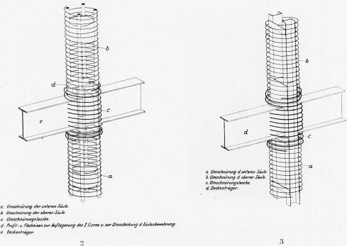
Fig. 2. — a Frettage du poteau inférieur = a Umschnürung der unteren Säule = a Spiral reinforcement of lower pillar.
