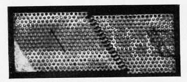
Fig. 4. — Tôle poinçonnée = Riffelblech = Chequered plate.
