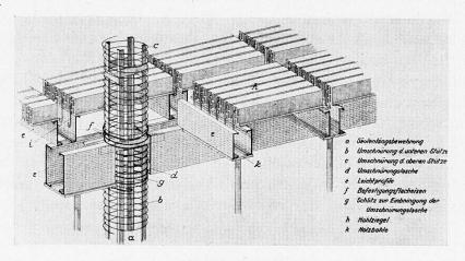
Fig. 9. — a Armature longitudinale du poteau = a Säulenlängsbewehrung = a Longitudinal reinforcement of pillar.
