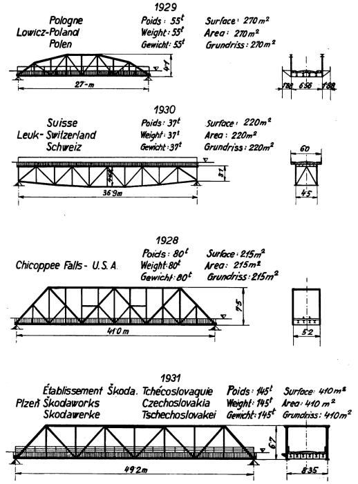
Fig. 4. — Ponts en treillis, complètement soudés.
