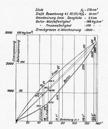
Rechnet man wieder für die Bereiche I und II (Bereich III war wegen des Einflusses der Umschnürung unsicher) die Formeln für die Lasten aus je drei Gleichungsgruppen für die gleichen Laststufen und die tatsächlichen Spannungen aus, so ergibt sich für den
