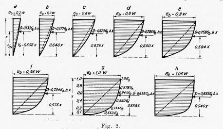
aus der die Veränderung des Spannungsdiagramms mit wachsenden  $\sigma_r$  deutlich zu erkennen ist. Die Spannungsverteilung ergibt sich nahezu dreieckförmig für
