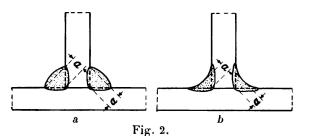
Volle und leichte Kehlnaht. Soudures d'angle normale et en congé. Full Fillet Weld and Light Fillet Weld.
