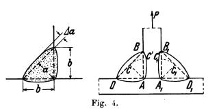
Kehlnähte sind (Bild 2ª) auch im Brükken bauzugelassen. Leichte Kehlnähte werden oft da angewendet, wo die Tragfähigkeit der Schweissnähte nicht voll ausgenützt werden kann, und wo eine Ausfüllung der Fugen mit Rücksicht auf etwaigen Wasserzutritt angezeigt erscheint. Tragende Kehlnähte sollen im allgemeinen
