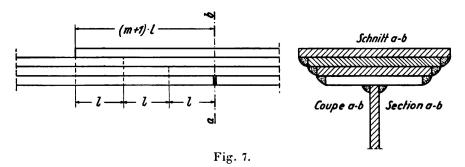
länge des Decklaschenanschlusses = (m + 1) l zu wählen, wo l die für eine Platte erforderliche Anschlusslänge ist. (Bild 7).
