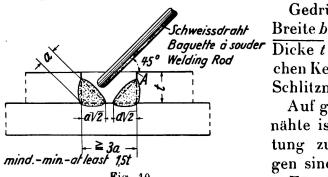
Gedrückte Gurtplatten, deren Verhältnis  $\frac{\text{Breite }b}{\text{Dicke }t} > 30$  ist, sind ausser mit seitlichen Kehlnähten noch mit mindestens einer Schlitznaht aufzuschweissen.
