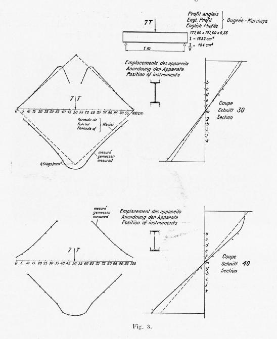
les tensions élémentaires dans la pièce et donnent des résultats moyens moins affectés par les effets locaux. Pour des constructions complexes et des cas de charges concentrées, il est donc avantageux d'apprécier le fonctionnement élastique par les flèches.
