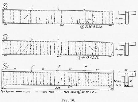
2) Das Tragvermögen der stahlbewehrten Balken ist um 29,3-34,5, respektive 42,8-50,4 % grösser bei der Serie B, resp. C und E, als die der Balken mit Flusseisenbewehrung. (Fig. 4.) Diese Zunahme entspricht bei Serie C und E der höheren Fliessgrenze des Siliciumstahles. Die Fliessgrenze des Siliciumstahles.
