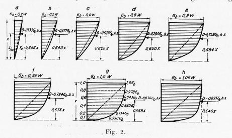
aus der die Veränderung des Spannungsdiagramms mit wachsenden  $\sigma_r$  deutlich zu erkennen ist. Die Spannungsverteilung ergibt sich nahezu dreieckförmig für
