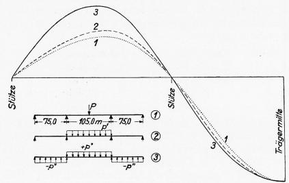
Fig. 1. — Conditions de charge admises et courbes élastiques pour la poutre continue.
