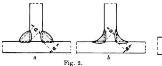
Volle und leichte Kehlnaht. Soudures d'angle normale et en congé. Full Fillet Weld and Light Fillet Weld.
