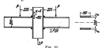
Es sollte die Tragfähigkeit der Schweissanschlüsse untersucht werden. Das von einem Trägeranschluss aufzunehmende Biegemoment ist
