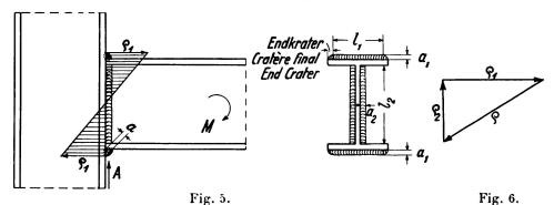
Die gleichzeitig auftretende Auflagerkraft A sucht die umgeklappte Schweissfläche  $F = \Sigma$  (a l) von unten nach oben abzuscheren. Nimmt man der Einfachheit halber gleichmässige Spannungsverteilung an, so entstehen in der umgeklappten Schweissfläche Scherspannungen:
