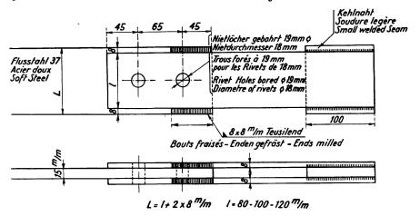
Il a été formé trois séries de ces éprouvettes dans lesquelles les tôles avaient, respectivement une largeur de 80 mm., 100 mm. et 120 mm.
