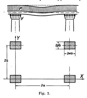
s'appuient divisent la plaque en panneaux rectangulaires qui se touchent, de longueur 2 a et de largeur 2 b (fig. 2). Les chapiteaux des piliers sont en contact avec la dalle suivant des aires également rectangulaires, orientées de la même manière, et dont les dimensions sont 2 a' et 2 b'. Nous admettons que les réactions des chapiteaux sont réparties uniformément, donc définies par la charge de l'unité de surface
