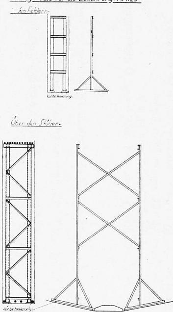
Fig. 3. — Chevalets de montage pour les armatures = Montageböcke für die Bewehrung = Scaffolding for erecting reinforcement.
