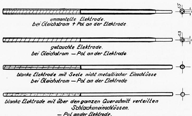
Fig. 1. — Electrodes pour soudure d'assemblage
