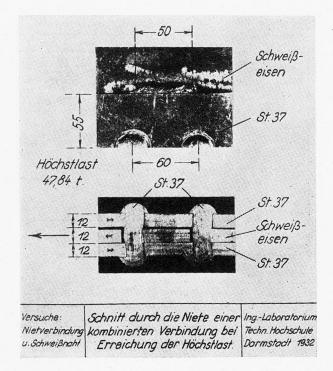
Fig. 4. — Coupe effectuée à la charge maximum dans un assemblage mixte, au milieu du rivetage = Schnitt durch die Niete einer kombinierten Verbindung bei Erreichung der Höchstlast = Section through the rivets of a combined connection on reaching maximum load.
