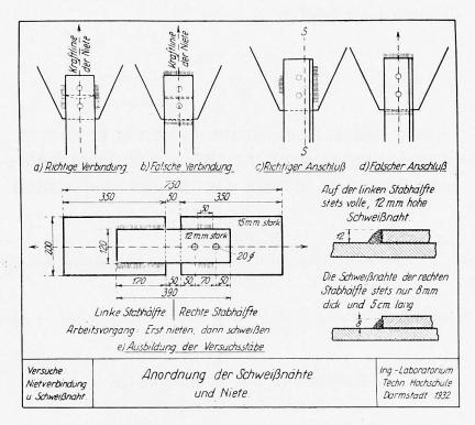
Fig. 1. - Disposition des cordons de soudure et des rivets Anordnung der Schweissnähte und Niete = Arrangement of the welded joints and rivets.
