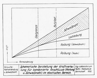
Fig. 5. — Représentation schématique de la répartition des efforts dans un assemblage combiné (rivure et soudure), dans le domaine élastique = Schematische Darstellung der Kraftverteilung für kombinierte Anschlüsse (Nietung und Schweissnaht) im elastischen Bereich = Diagrammatic representation of the distribution of forces in combined connections (riveting and welding) in the elastic zone.
