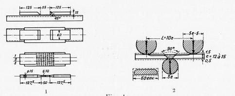
Fig. 1. Éprouvette de traction, type Arcos, avec prise d'allongement dans le métal de soudure. Zug-Versuchskörper, Typus Arcos, Messung der Dehnung im Schweissgut.
