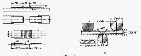
Fig. 1. Éprouvette de traction, type Arcos, avec prise d'allongement dans le métal de soudure. Zug-Versuchskörper, Typus Arcos, Messung der Dehnung im Schweissgut. Tensile piece, Arcos type; measurement of elongation in the weld metal.
