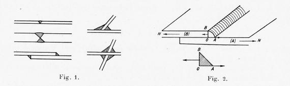
sollicité à la traction sur une de ses faces et au cisaillement sur l'autre. Il conviendra donc de vérifier la fatigue à la traction du cordon sur la face OB et la fatigue au cisaillement sur la face OA.
