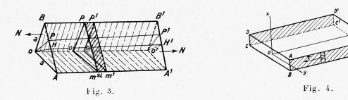
Soit une tôle de section droite A B C D, A'B'C'D' que nous supposerons rapportée aux axes ox, oy, oz. Les deux faces parallèles A B A'B' et C D C'D' sont soumises à l'effort de cisaillement  $\tau$  que nous supposerons variable, dirigé dans leur plan parallèlement à oz.  $\tau$  est une fonction de la variable z.
