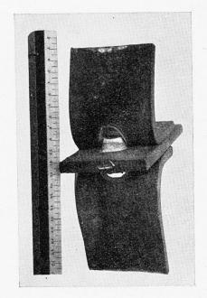
Fig. 6. Éprouvette II + II + II déboutonnée = Versuchskörper II + II + II aufgeknöpft = Test piece II + II + II pulled apart.
