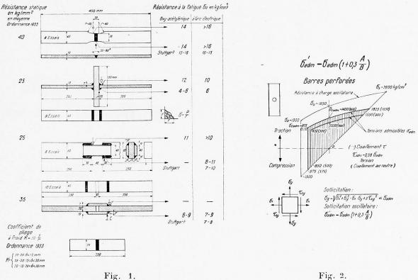
Grundlagen betreffend Ermüdungsfestigkeit liefern und dadurch eine genauere Festsetzung der zulässigen Spannungen ermöglichen, werden für gelochten Konstruktionsstahl — genietete Konstruktionen — in Anpassung an die Versuchsergebnisse nachfolgende Beziehungen empfohlen
