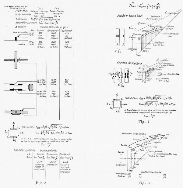
Bei gleichzeitigem Zusammenwirken von Normalspannungen  $\sigma_x$  und  $\sigma_y$  und Schubspannungen  $\tau_{x,y}$  — zwei- bezw. dreiaxige Spannungszustände — wird gleichfalls die Theorie der konstanten Gestaltänderungsenergie als gültig ange-
