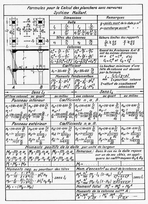
Fig. 7. — Formules pour le calcul des planchers sans nervures. Système Maillart = Formeln zur Berechnung der unterzugslosen Decken, System Maillart = Formulae for calculating floors without ribs, Maillart system.
