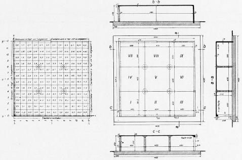
Fig. 3. —Mur de béton avec articulations en tête et en pied = Betonwand mit Kopf- und Fussgelenken = Concrete wall with joints at top and bottom.
