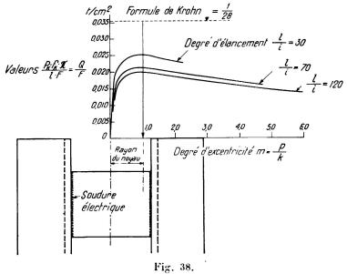
Valeurs  $\frac{Q}{F}$  pour différents degrés d'élancement et d'excentricité. — Acier de construction.
