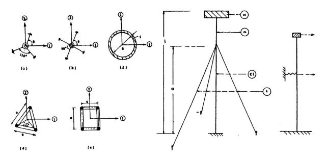
FIG-1 TYPICAL GUY TOWER CONFIGURATIONS
