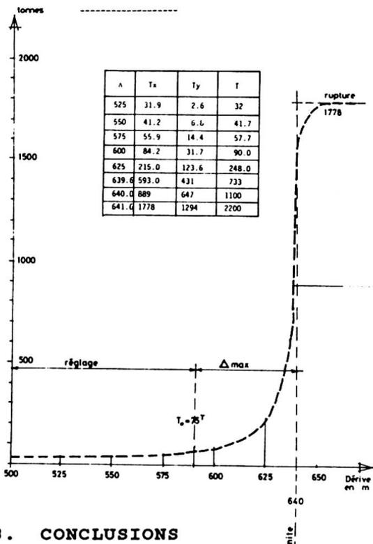
Variation de la composante horizontale dans les câbles en fonction de la dérive de la plate-forme.
