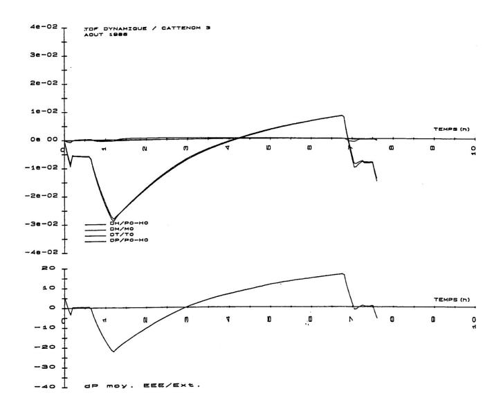
Figure 5 : Evolution de la variation de masse d'air sec dans l'espace entre-enceinte en fonction du temps et de la pression.
