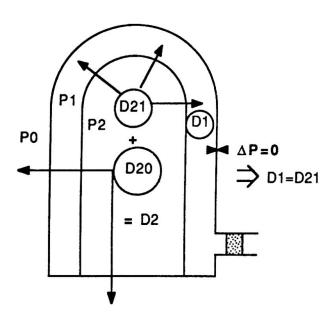
L'enceinte interne étant préssurisée à la pression nominale d'essai, on dépressurise l'espace entre-enceinte à environ - 10 mbar, puis on isole l'ensemble. Lorsque l'équipression entre P0 et P1 est réalisée, l'échange gazeux avec l'extérieur ne se fait plus que par les fuites "directes". Si on mesure simultanément les débits de fuites globaux D2 et D1 à l'instant précis ou  $\Delta P = 0$ , on obtient le débit de fuites "directes" D20 par différence :
