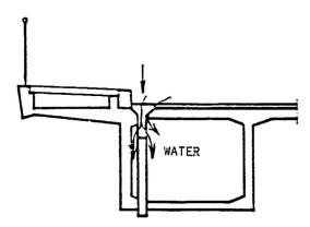
Fig. 6 - DAMAGED DRAINING SYSTEM
