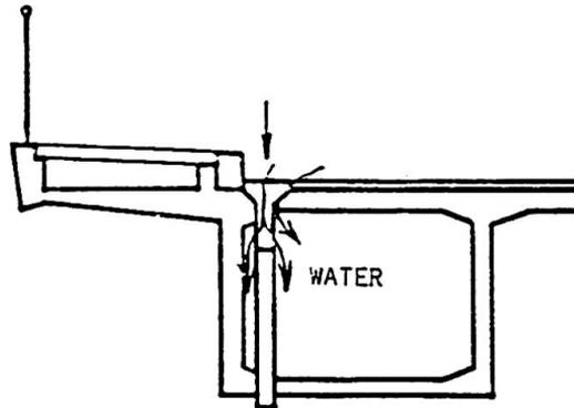
Fig. 6 - DAMAGED DRAINING SYSTEM
