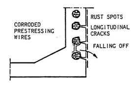
Fig. 11 - POORLY GROUTED TENDONS
