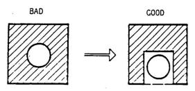
Fig. 5 - DRAINING TUBES
