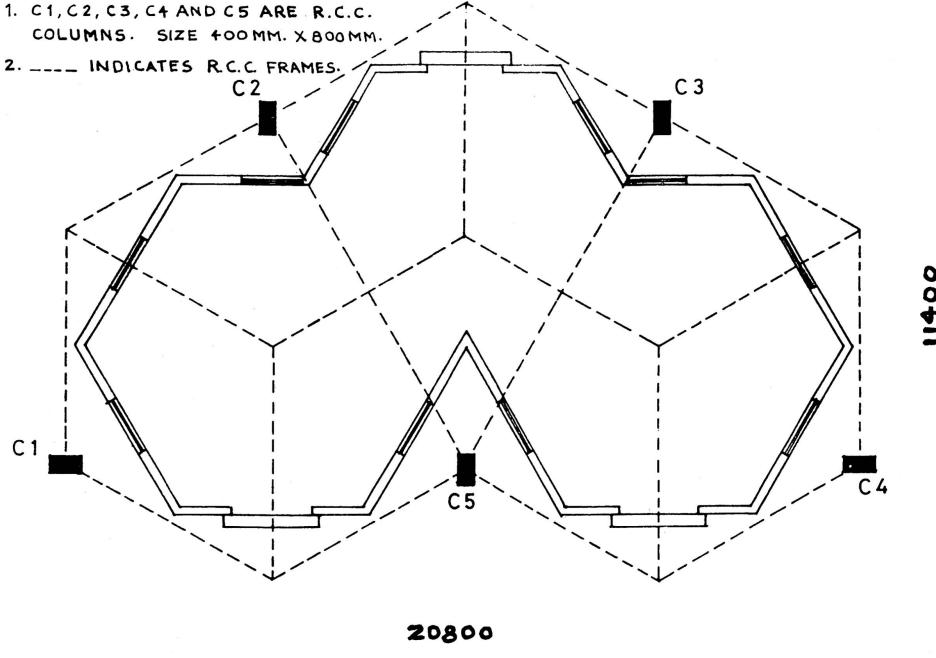
FIG.1 GROUND PLAN AND LOCATION OF COLUMNS
